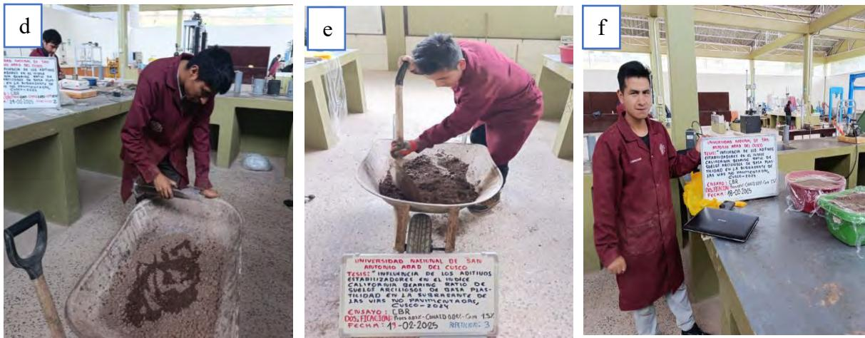
**Fotografía F.19:** Compactado de las muestras de CBR para golpes de 12, 26 y 55 golpes
