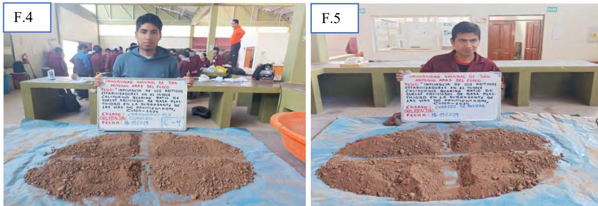
**Fotografía F.9:** Lavado de muestras de las calicatas C-1, C-2, C-3, C-4 y C-5 para el ensayo de granulometría por tamizado
