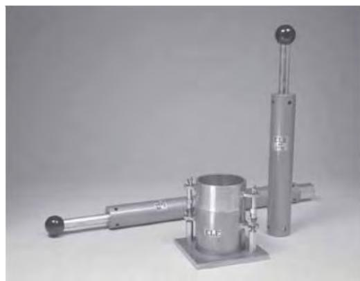
Nota: La imagen muestra las herramientas utilizadas para llevar a cabo el ensayo de Proctor. Fuente: Das (2013).
