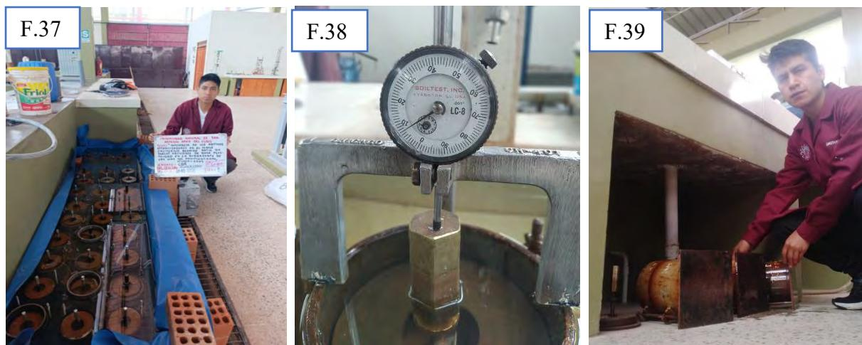
**Fotografía F.22:** Penetración de muestras con el equipo de CBR
