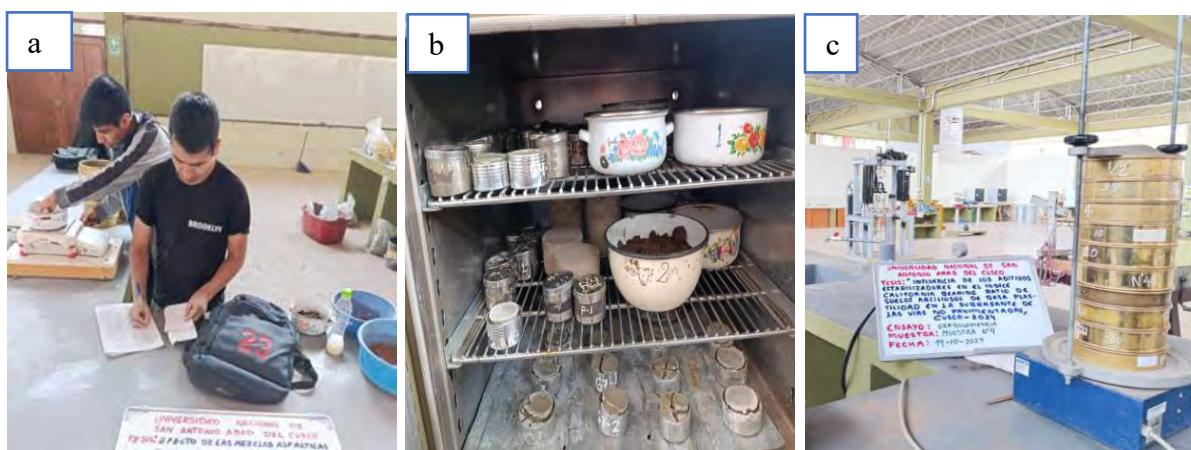
Las fotografías a, b y c muestran el pesado, la colocación en el horno y el tamizado mecánico de las muestras.
