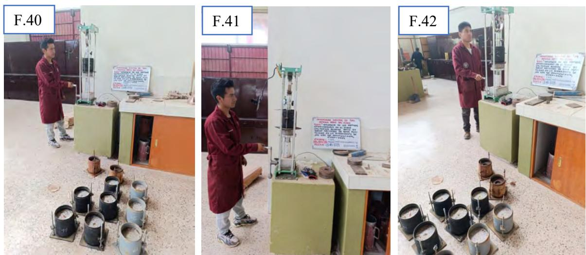
Anexo G.3.4: Imágenes de Ensayo de Resistencia a la Compresión Simple de suelos tratados
