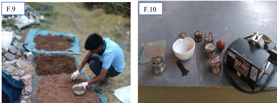
**Fotografía F.11:** Procedimientos del ensayo de límite líquido de las calicatas C-1, C-2, C-3, C-4 y C-5
