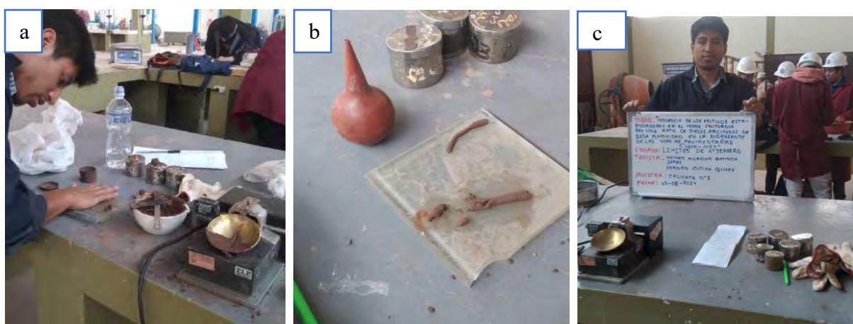
Las fotografías a, b y c muestran los procedimientos para determinar el límite plástico de las calicatas C-1, C-2, C-3, C-4 y C-5.
