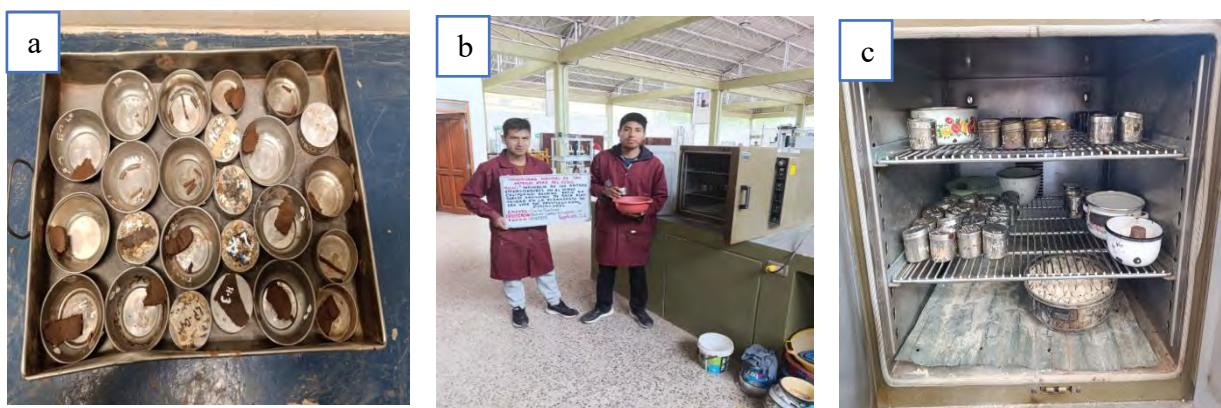
Las fotografías a, b y c muestran la capsulas para determinar el contenido de humedad.
