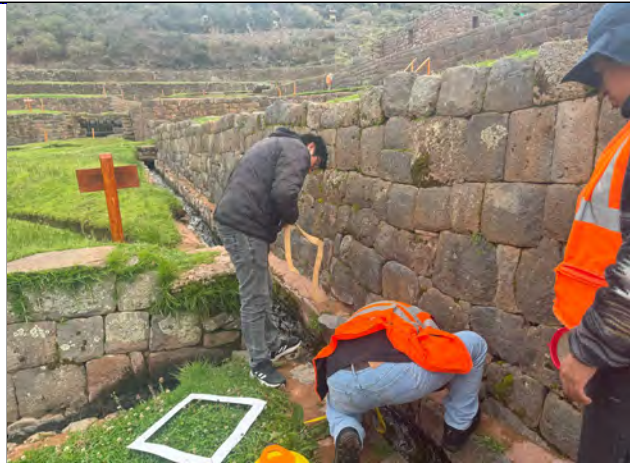
FOTO N° 90 toma de las medidas de la seccion del canal C-L05 para poder grabar y obtener su velocidad
