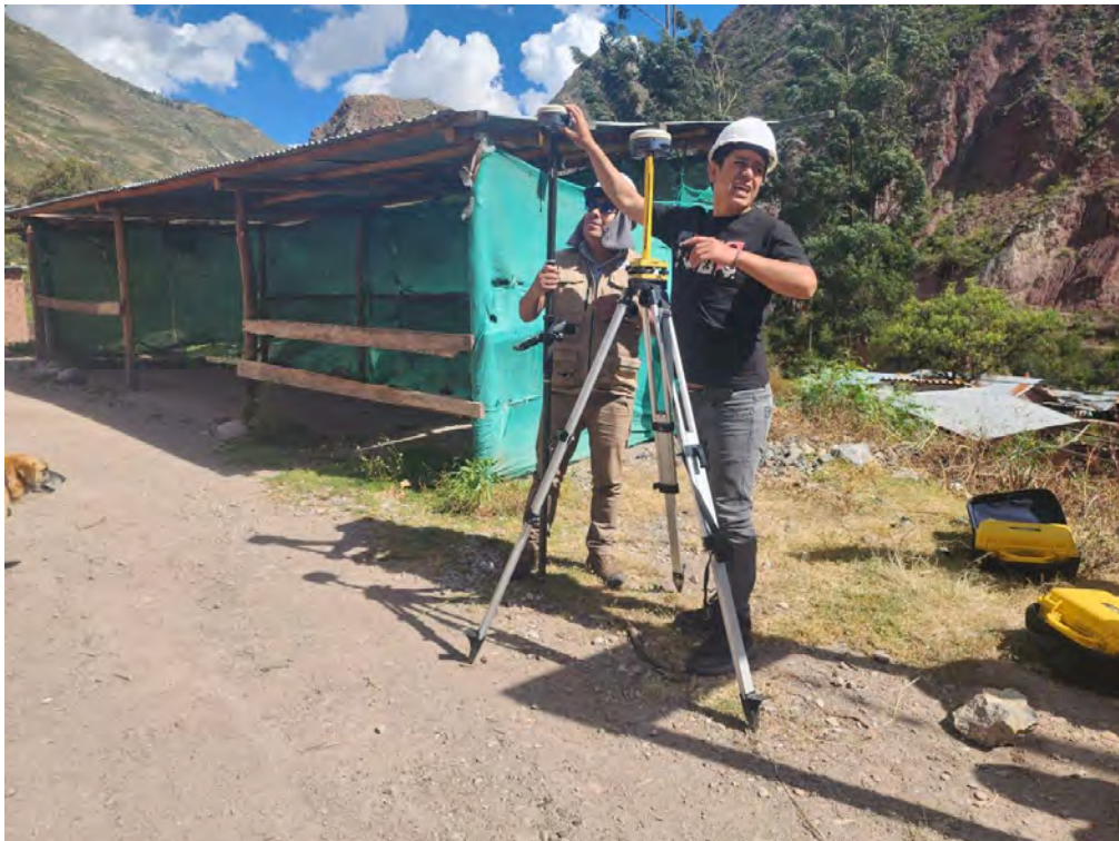
FOTOGRAFIA N°2: Instalación del GPS Diferencial para que trabaje en modo PPK
