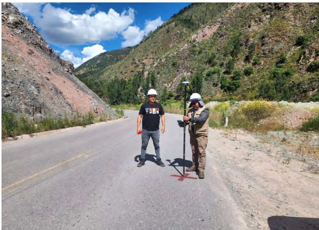
FOTOGRAFIA N°2: Registro con el GPS de la dinas – para su posterior restitución
