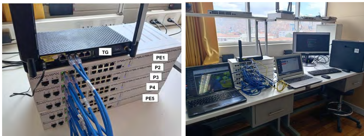
Figura 4.3.1 Configuración de VPLS sobre IP/MPLS
