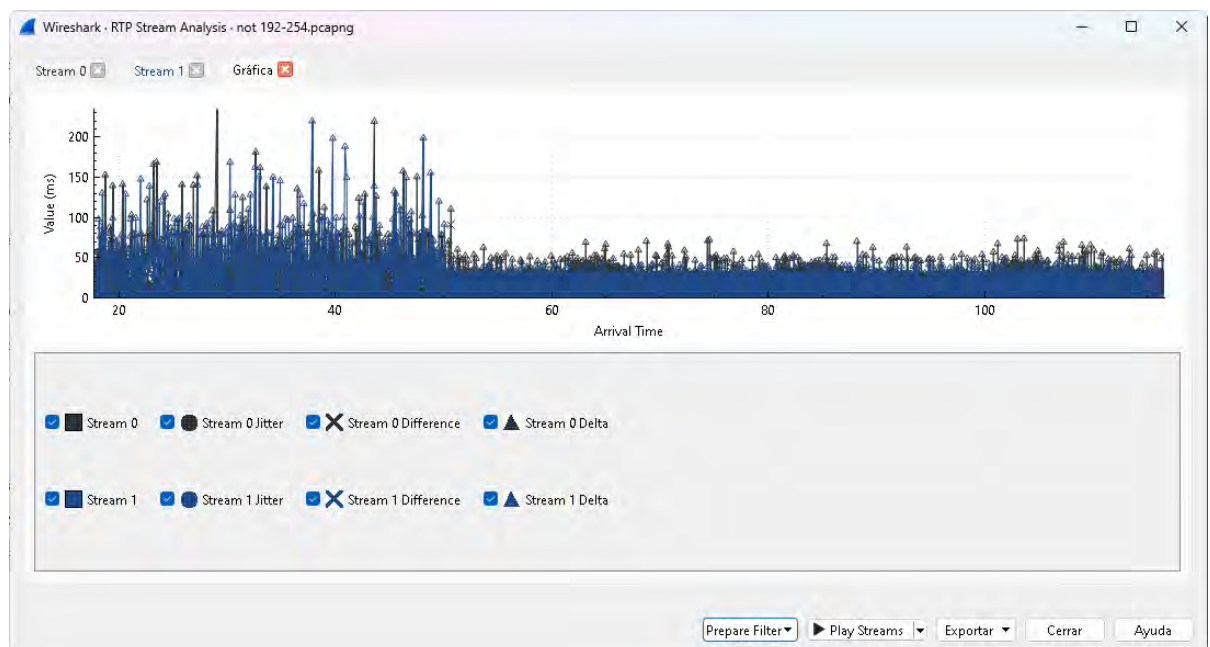
Figura 5.6.15 Flujo de datos RTP bidireccional
