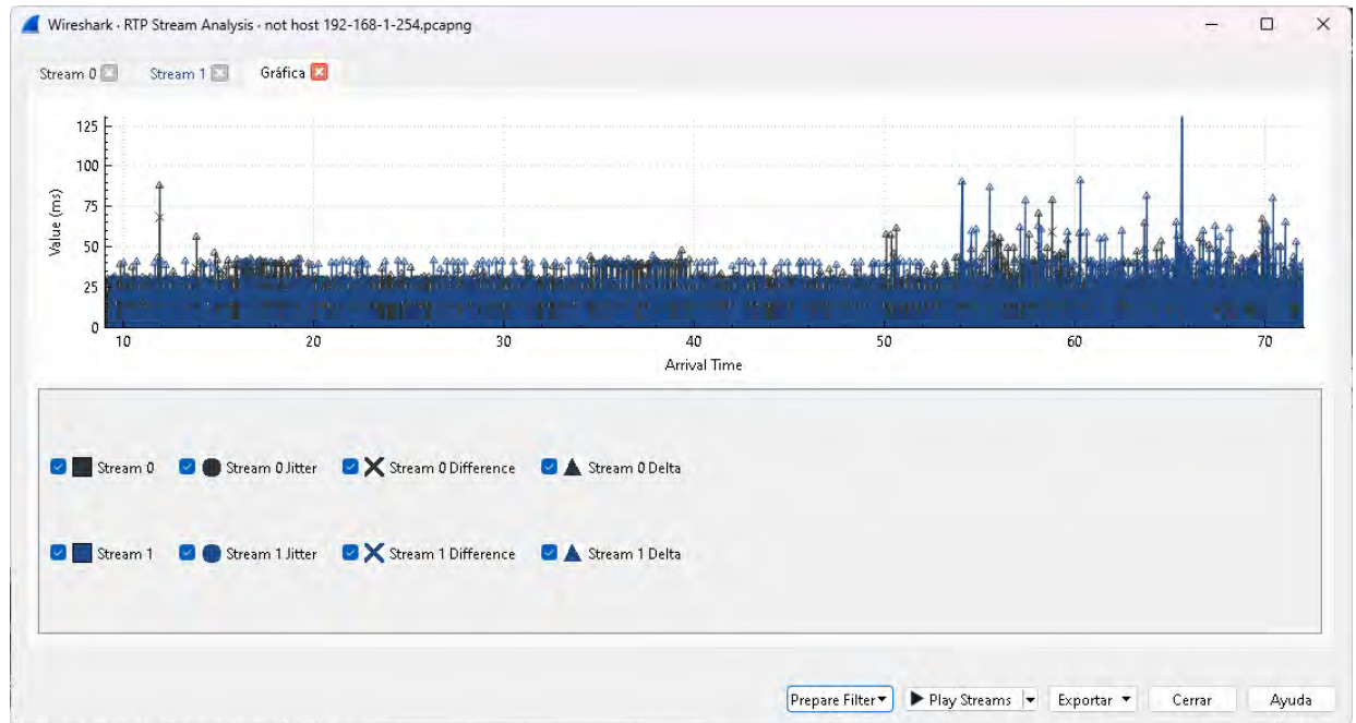
Figura 5.6.4 Representa un flujo de datos bidireccional de una llamada (videollamada)
