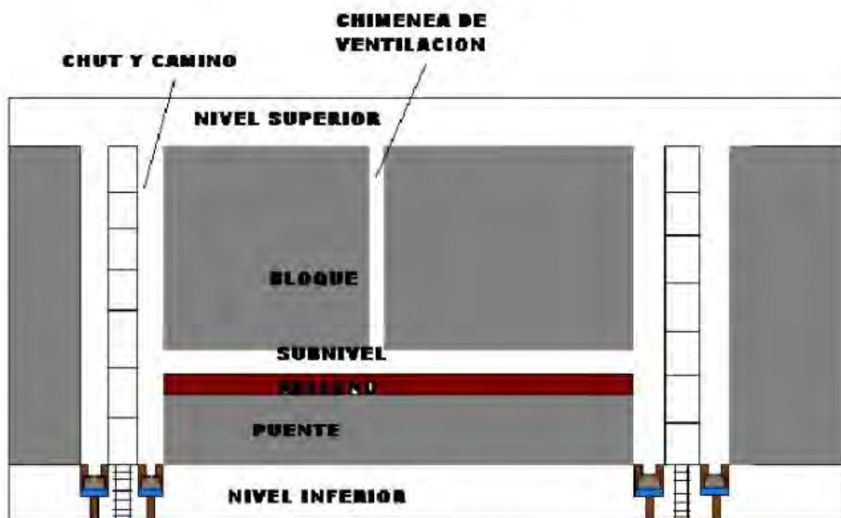
Figura 6 Método de corte y relleno ascendente ( Cut and Fill, upward )
