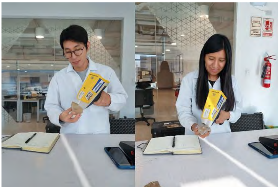
Figura 9: Disparos y lectura de la muestra de roca
