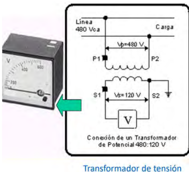
Figura 2.1 Diagrama de conexión T.T
