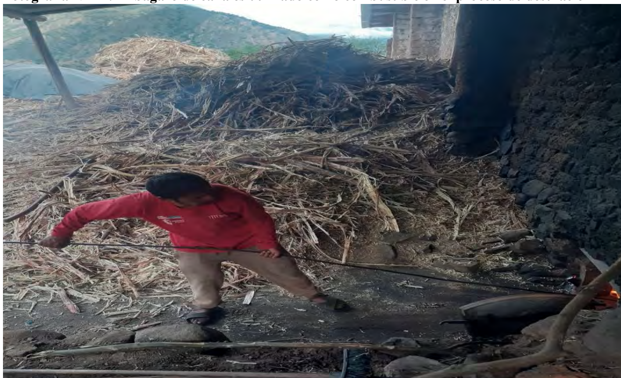
Fotografía N°-17: El bagazo de caña es utilizado como combustible en el proceso de destilación
