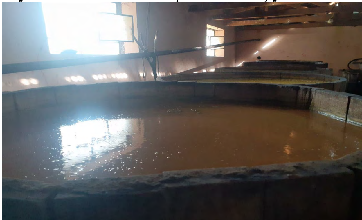
Fotografía N°-15: Toneles de madera utilizados para la fermentación de jugo de caña
