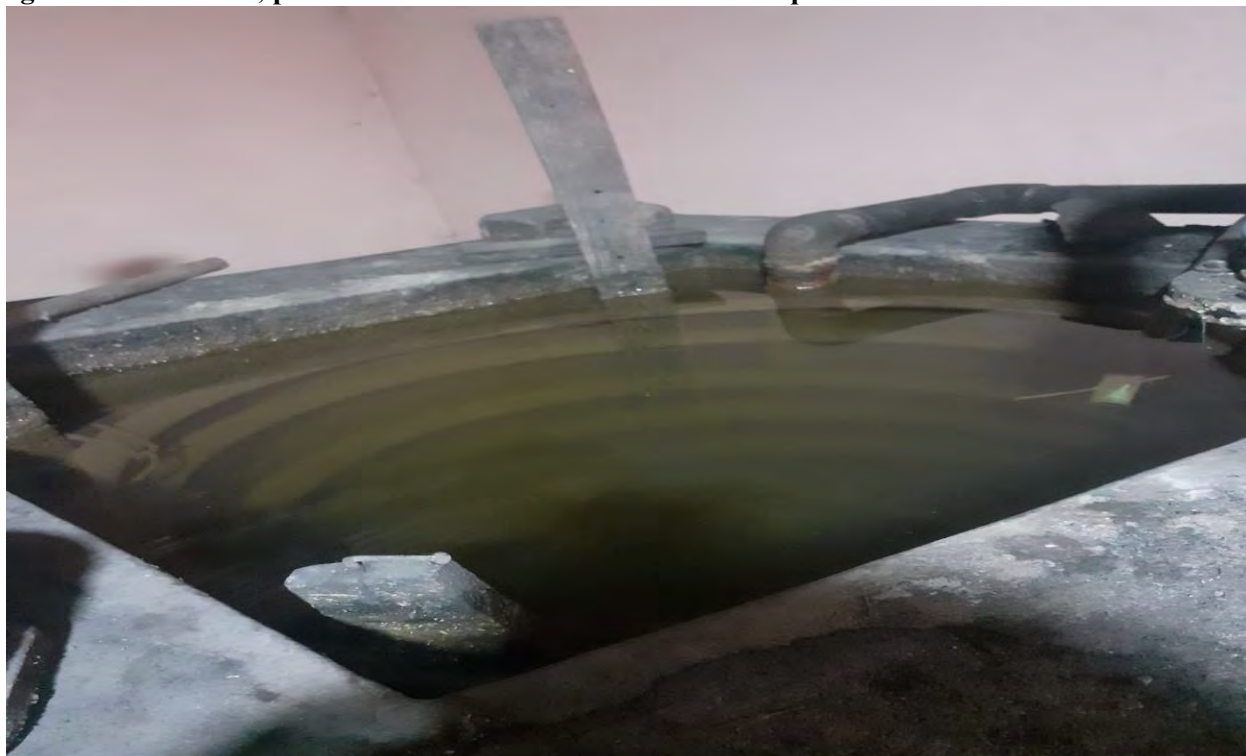
Fotografía N°-19: El serpentín es una parte del alambique encargada de enfriar el vapor del aguardiente de caña, permitiendo su condensación en estado líquido
