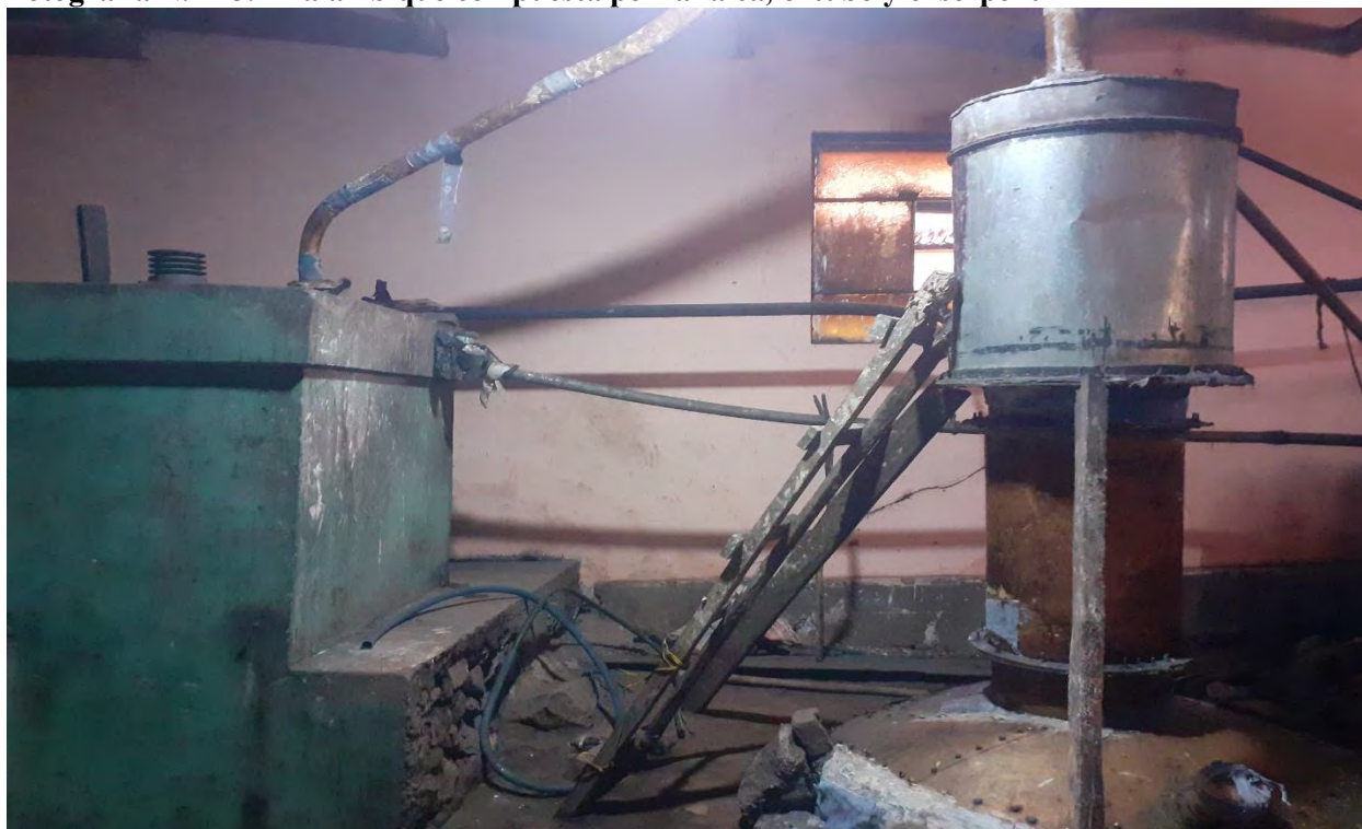
Fotografía N.º-18: El alambique compuesta por la falca, el tubo y el serpentín
