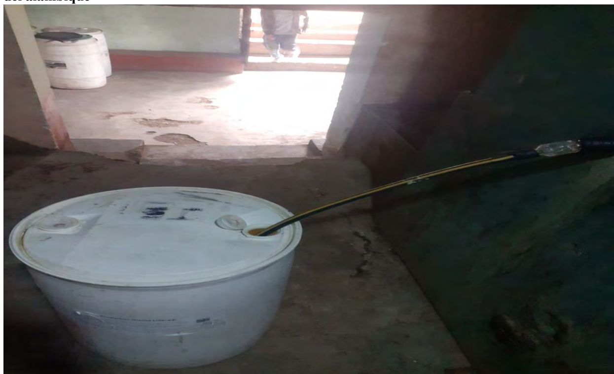
Fotografía N°-24: El aguardiente de caña es recolectado en un cilindro tras pasar por el serpentín del alambique
