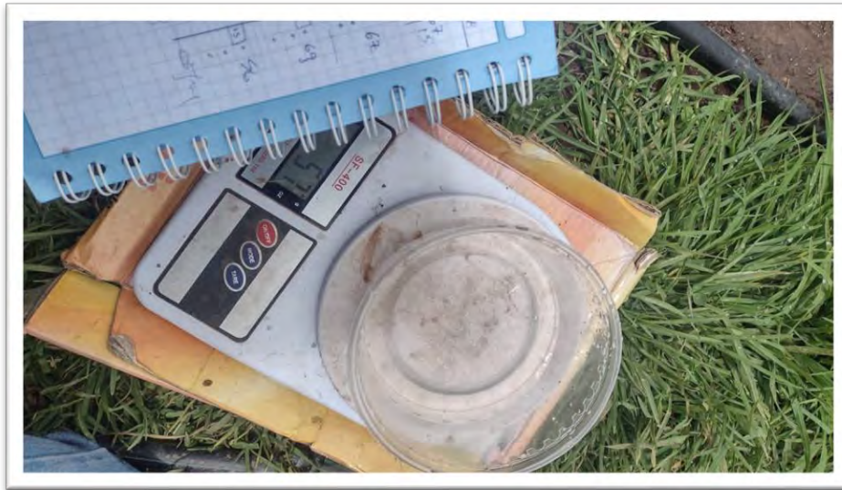
Figura 10: Evaluación del coeficiente de uniformidad
