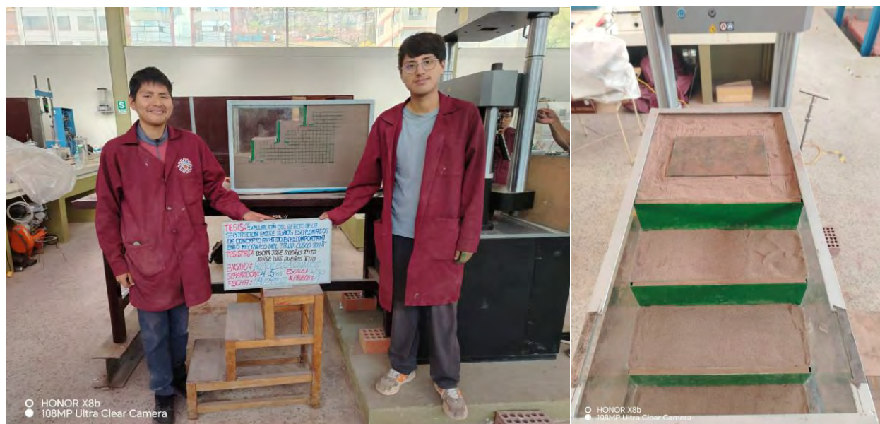
Figura 59. Modelo físico a escala reducida, separación de 4.50 m entre muros.
