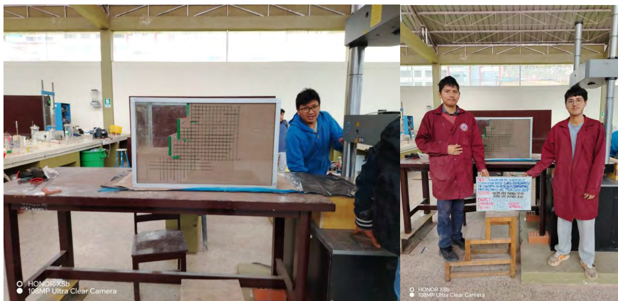
Figura 57. Modelo físico a escala reducida, separación de 1.50 m entre muros.
