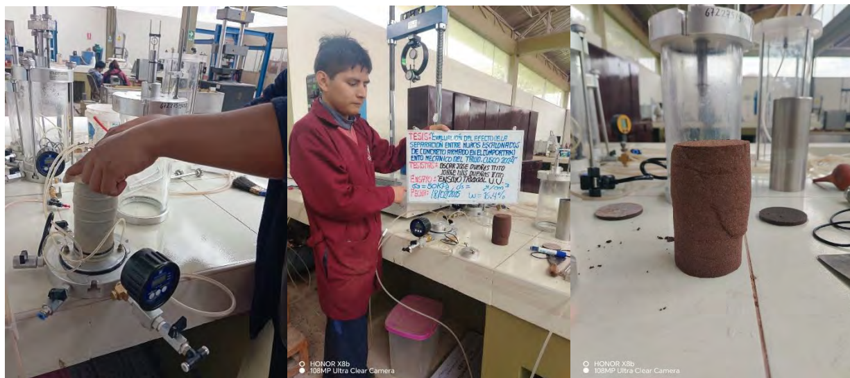
Figura 35. Ensayo triaxial UU para muestra a humedad óptima, para \sigma_3=50\text{kPa}
