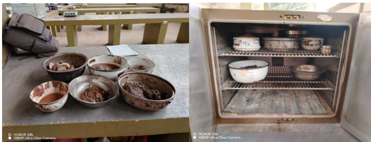
Figura 26. Lavado de material para ensayos de clasificación
