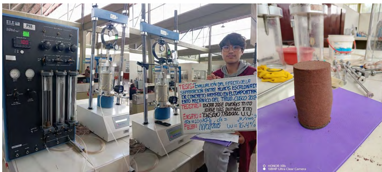
Figura 36. Ensayo triaxial UU para muestra a humedad óptima, para \sigma_3=100\text{kPa}
