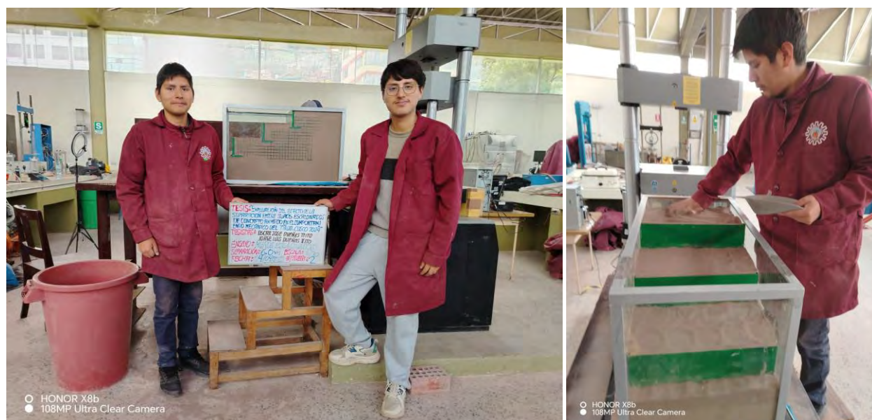
Figura 60. Modelo físico a escala reducida, separación de 6.0 m entre muros.
