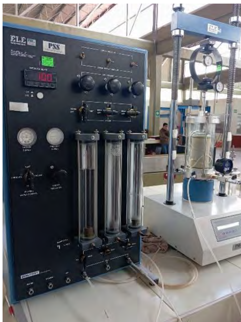
Figura 31. Equipo triaxial Estático del laboratorio de Mecánica de Suelos, UNSAAC
