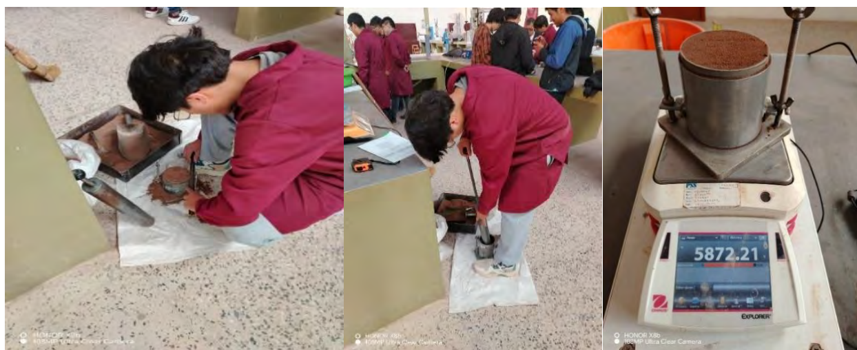
Figura 30. Ensayo de proctor modificado para arena limosa.
