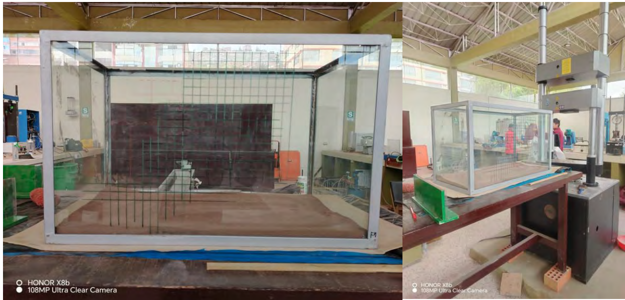
Figura 55. Marco experimental cuadriculado para registro de desplazamientos.
