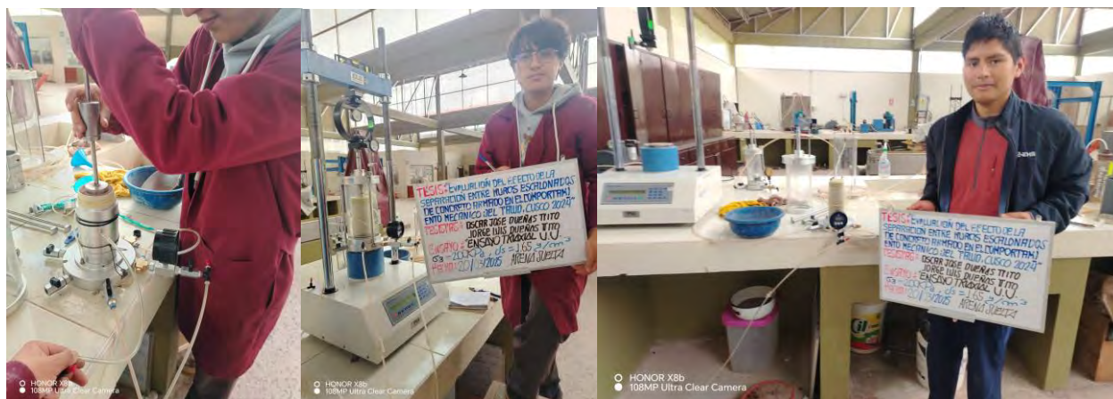
Figura 40. Ensayo triaxial EN SECO compactado, para confinamientos de 200kPa
