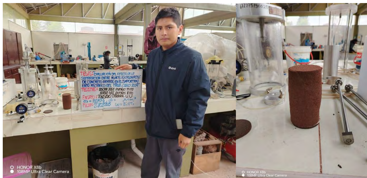
Figura 37. Ensayo triaxial UU para muestra a humedad óptima, para \sigma_3 = 200 \text{ kPa}
