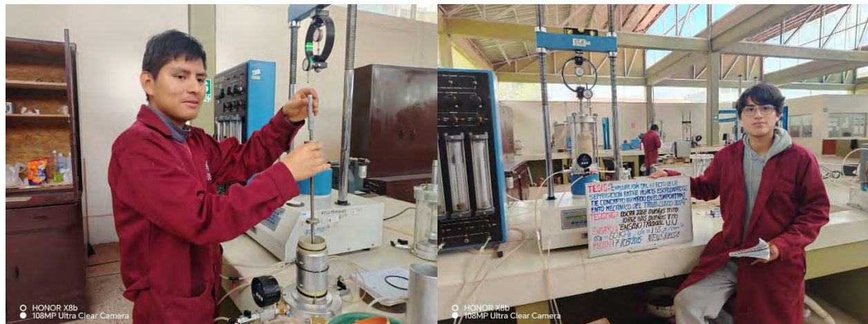
Figura 38. Ensayos triaxial EN SECO compactado, para confinamientos de 50kPa
