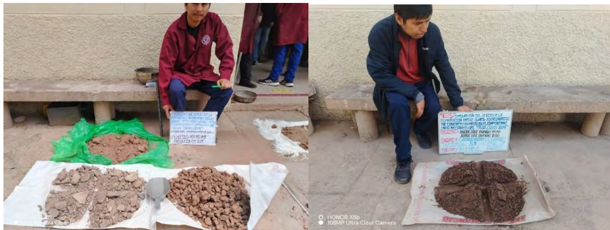
Figura 25. Cuarteo de muestras del talud, material S1, S2, S3 y S4.
