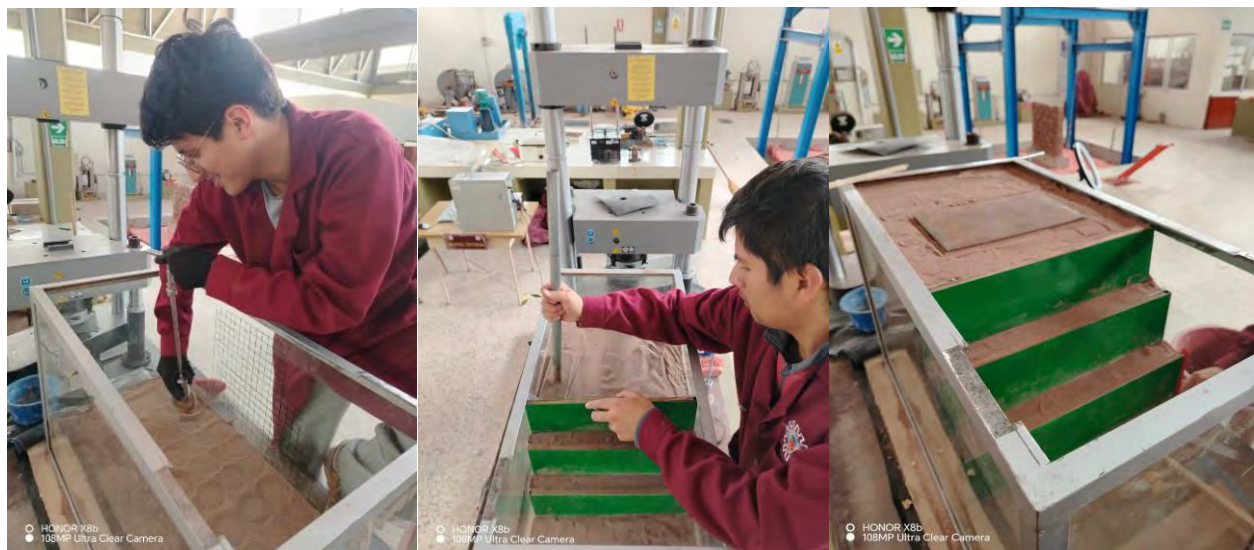
Figura 56. Armado y compactación de modelo a escala.
