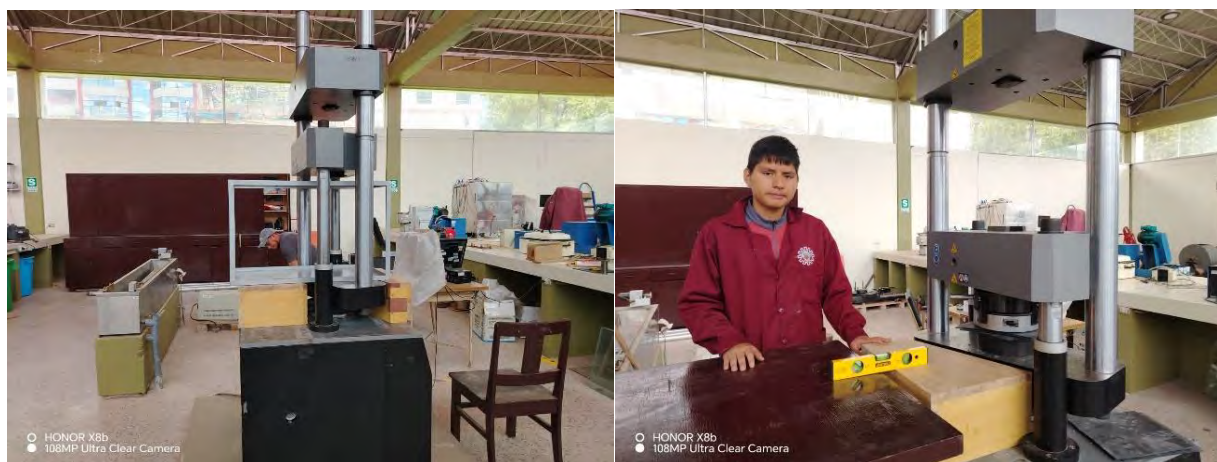
Figura 52. Mesa de trabajo a nivel del equipo universal con los apoyos puestos.
