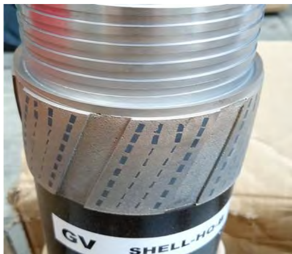
Figura 4 Reaming Shell Impregnada con Diamante (Fuente: Guizhou Vilong Equipment Co., Ltd).
