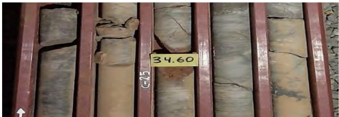
FOTO 1. VISTA EN PLANTA TACO CON INFORMACION DE PROFUNDIDAD Y NUMERO DE CORRIDA EN CAJA
