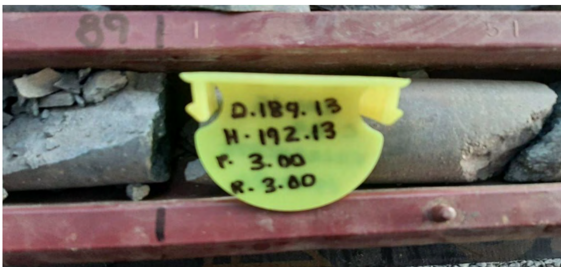
FOTO 2. VISTA TACO CON INFORMACION DE PERFORACION
