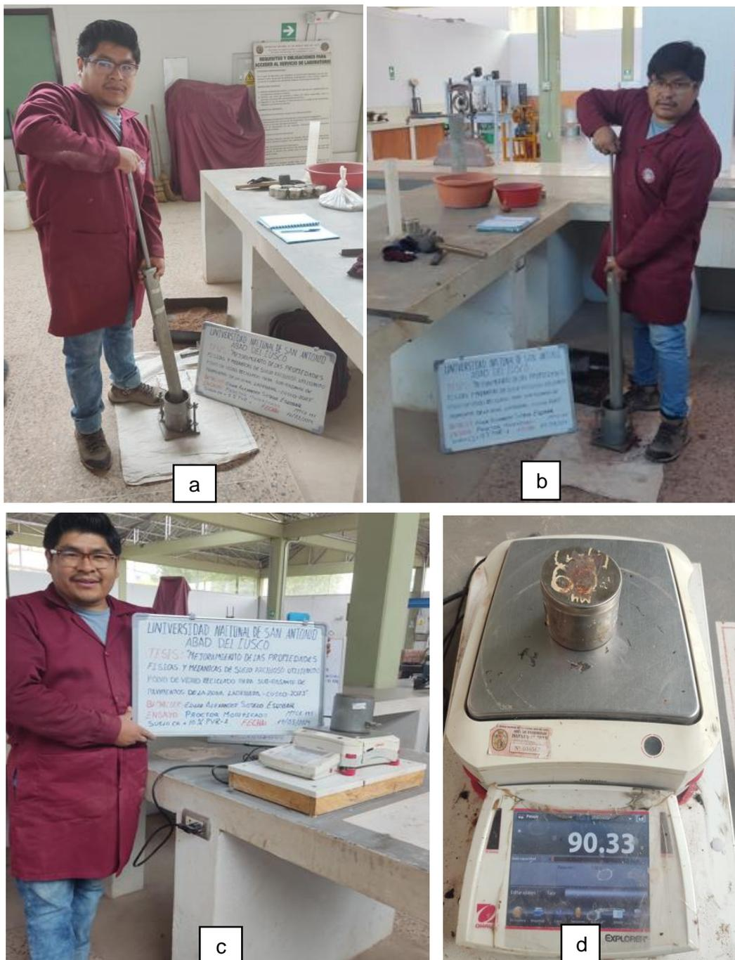
*Nota.* En las figuras a y b podemos observar la compactación de material de suelo arcilloso CH y CL mezclado con los diferentes porcentajes de polvo de vidrio reciclado para el ensayo de proctor modificado y en las figuras c y d podemos apreciar el pesado del molde con el material compactado para ensayo proctor modificado.
