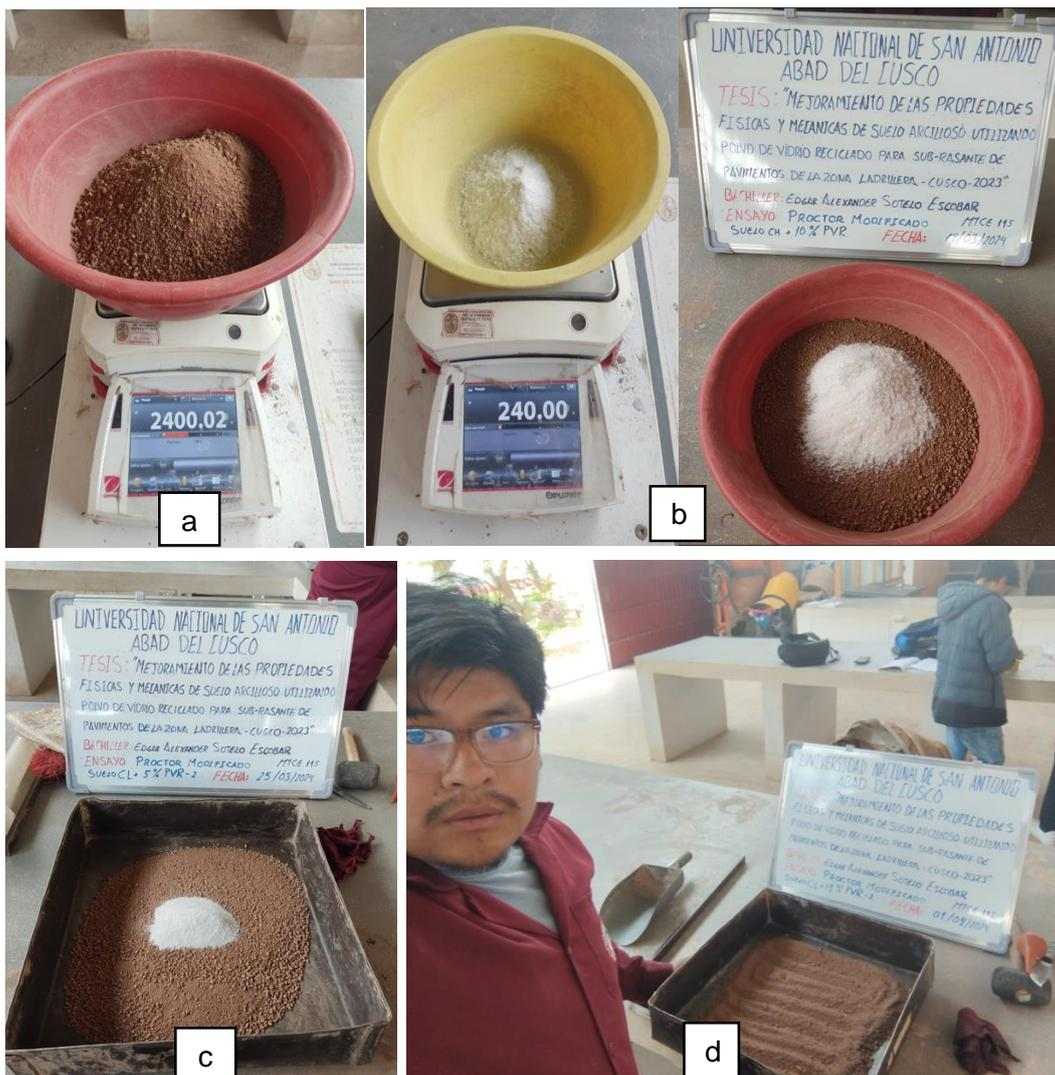
*Nota.* En las figuras a y b podemos observar el pesado de material de suelo arcilloso CH y CL y pesado de polvo de vidrio reciclado en los diferentes porcentajes y en las figuras a y b podemos apreciar el procedimiento de mezclado del material de suelo arcilloso CH y CL con los diferentes porcentajes de polvo de vidrio reciclado para el ensayo de proctor modificado.
