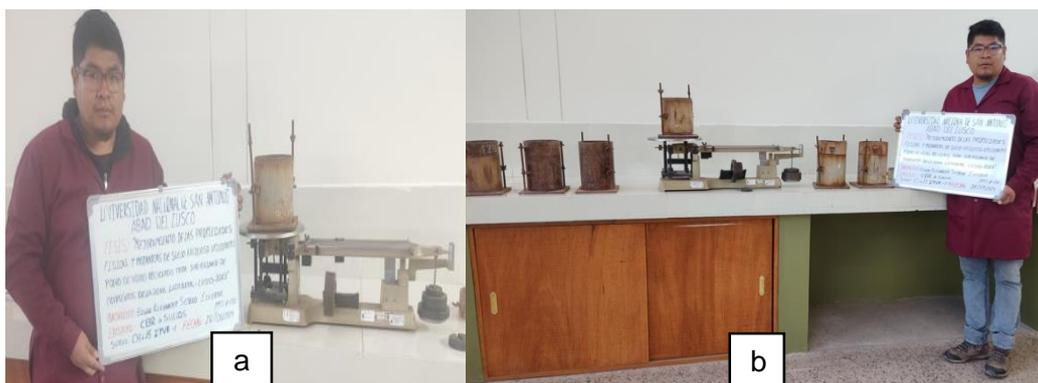
*Nota.* En las figuras a, b y c podemos apreciar el pesado del molde con el material compactado para ensayo CBR.
