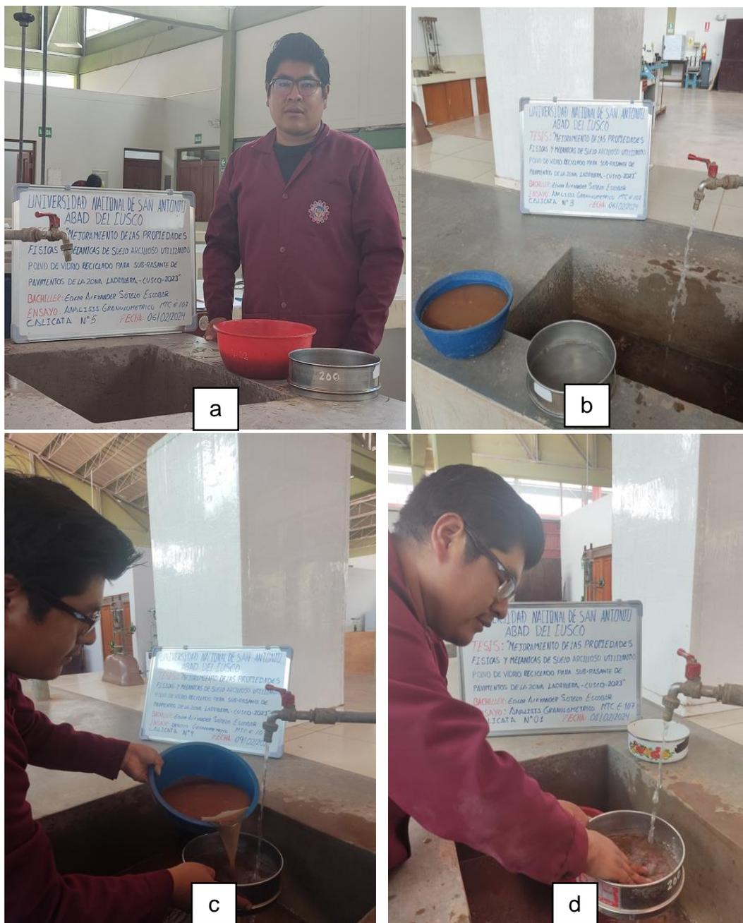
**Nota.** En las figuras a y b podemos observar los materiales para realizar el lavado de muestra de suelo arcilloso por la malla N°200. Y en las figuras c y d se muestra dicho lavado mencionado.
