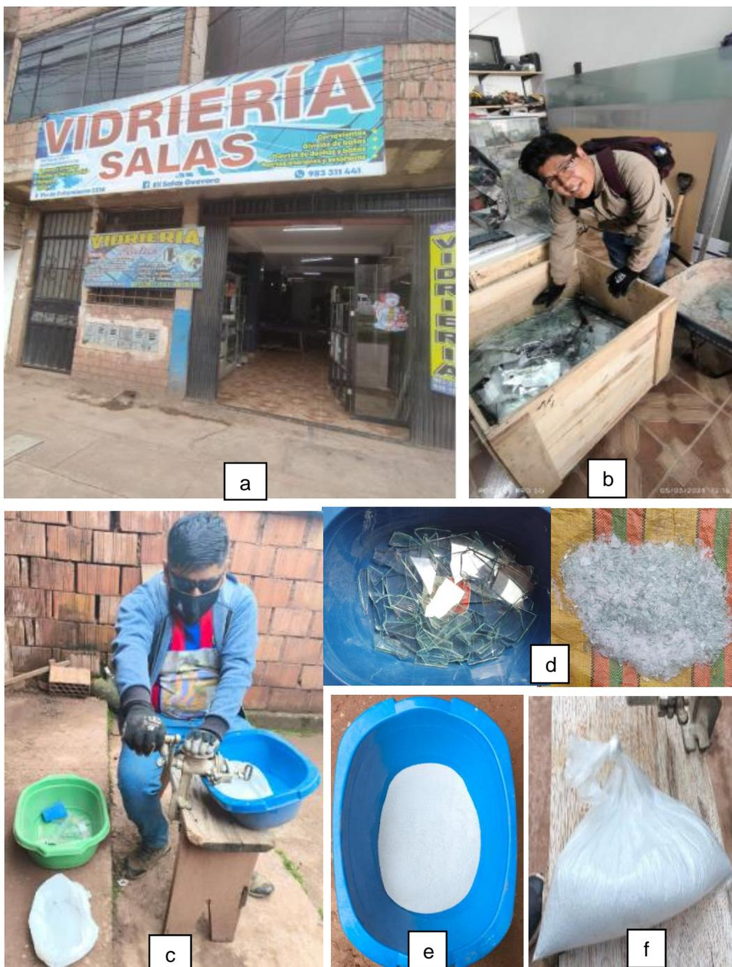
*Nota.* En las figuras a y b podemos apreciar el local de la vidriería “SALAS” de donde se recolecto los pedazos de vidrio y en las figuras c, d, e y f podemos observar el proceso de trituración y molida del vidrio reciclado hasta obtener polvo.
