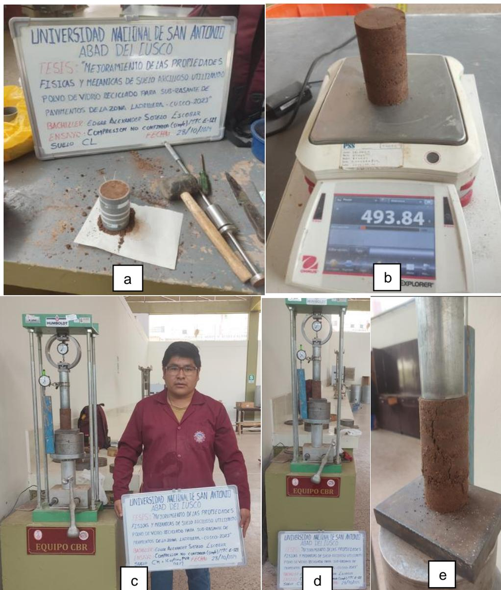
*Nota.* En las figuras a y b podemos observar el pesado de las probetas cilíndricas y en las figuras c, d y e observamos la colocación de las probetas cilíndricas en el aparato de compresión se aplica la carga hasta que se produzca la rotura.
