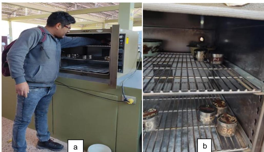
*Nota.* En las figuras a y b observamos la colocación de las capsulas dentro del horno para así determinar contenidos de humedad.
