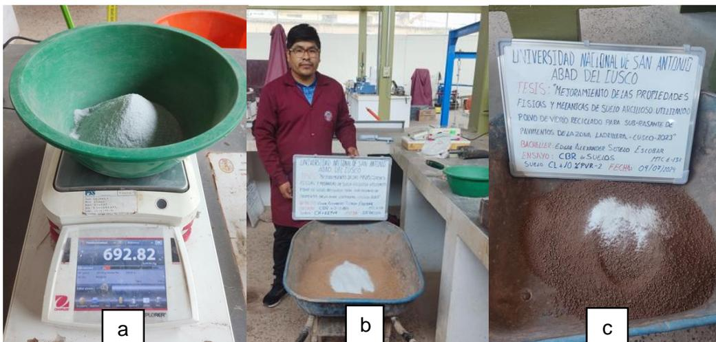
*Nota.* En las figuras a, b y c podemos observar el pesado de material de suelo arcilloso CH y CL y pesado de polvo de vidrio reciclado en los diferentes porcentajes.
