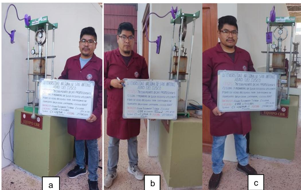
*Nota.* En las figuras a, b y c podemos observar el procedimiento de penetración de los moldes de 12, 25 y 56 golpes de los suelos CH y CL mezclado con diferentes porcentajes de polvo de vidrio reciclado.
