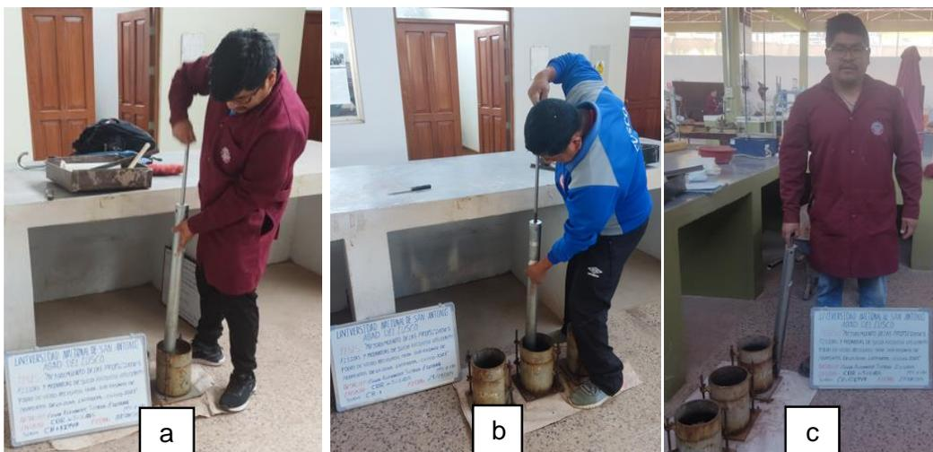
*Nota.* En las figuras a, b y c podemos apreciar la compactación de material de suelo arcilloso CH y CL mezclado con los diferentes porcentajes de polvo de vidrio reciclado para el ensayo de CBR.
