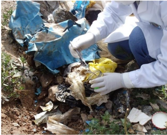
Foto 4. Proceso de muestreo en superficie de bolsas de plástico con signos de deterioro.
