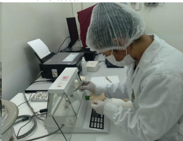
Foto 15. Pesado de las muestras de LDPE en Ultramicrobalanza
