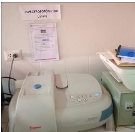
Figura N°09: Medición de la absorbancia a 517nm en el espectrofotómetro UV-Visible.
