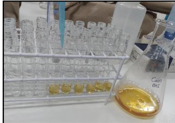
**FOTOGRAFÍA N°90:** Incorporación de 1mL de caldo BHI a cada tubo de ensayo, para luego ser esterilizado en autoclave.
