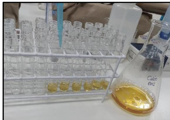
**FOTOGRAFÍA N°28:** Incorporación de 1mL de caldo BHI a cada tubo de ensayo, para luego ser esterilizado en autoclave.
