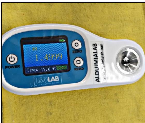
**FOTOGRAFÍA N°20:** Determinación del índice de refracción del aceite esencial de *Piper aduncum* (Matico).
