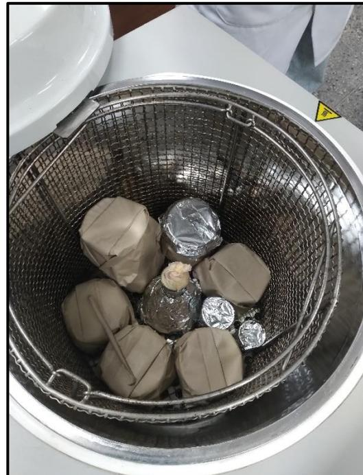
**FOTOGRAFÍA N°69:** Esterilizar el medio de cultivo y los materiales en autoclave a 121°C por 15 minutos.
