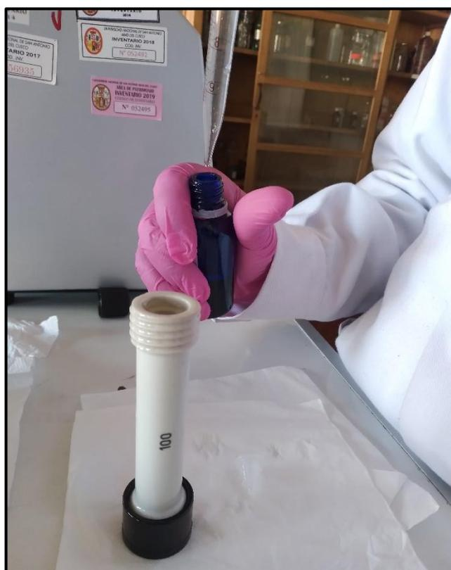
**FOTOGRAFÍA N°22:** Preparación de la muestra de aceites esenciales para la determinación de la rotación óptica.
