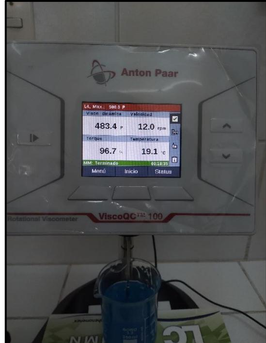
**FOTOGRAFÍA N°58:** Medición de la viscosidad del gel dental elaborado.
