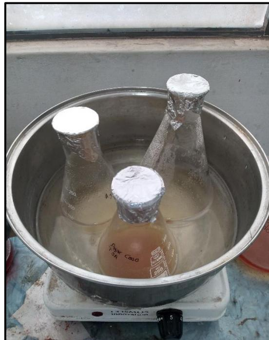
**FOTOGRAFÍA N°102:** Disolución del agar nutritivo en baño maría para luego ser esterilizado en autoclave.
