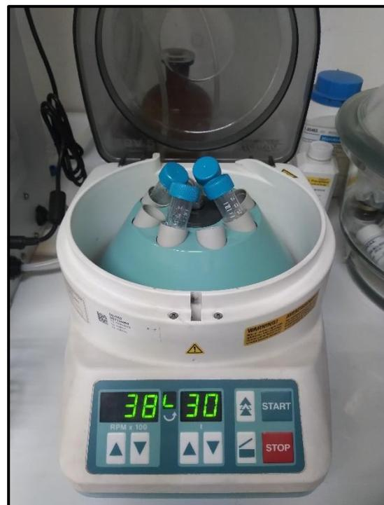
**FOTOGRAFÍA N°61:** Evaluación de la estabilidad acelerada mediante el uso de la centrifuga a 3800 rpm por 30 minutos.
