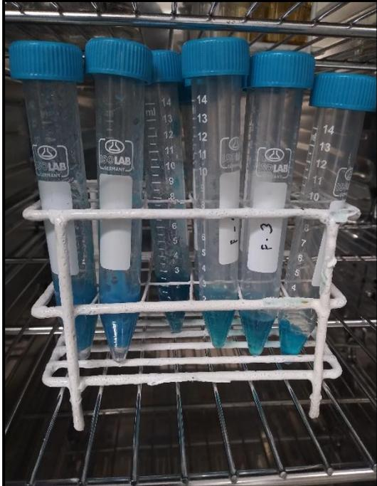
**FOTOGRAFÍA N°64:** Prueba de calentamiento, se llevó las muestras a la estufa a 40°C por 24 horas.
