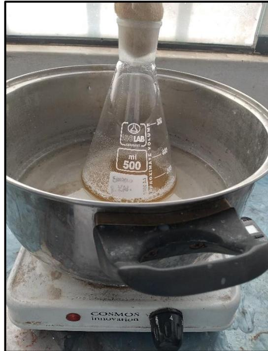
**FOTOGRAFÍA N°96:** Disolución del agar nutritivo en baño maría para luego ser esterilizado en autoclave.
