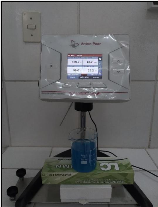
**FOTOGRAFÍA N°57:** Medición de la viscosidad del gel dental elaborado.
