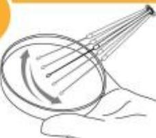
Con un lazo estéril, forme estrias longitudinales para facilitar el aislamiento de las colonias.
