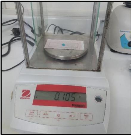
**FOTOGRAFÍA N°50:** Determinación de la extensibilidad del gel dental. Peso de la muestra.
