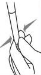
Pellicando la parte inferior de la unidad, aplaste el pellet en el líquido hasta que la suspensión del pellet sea homogénea.
