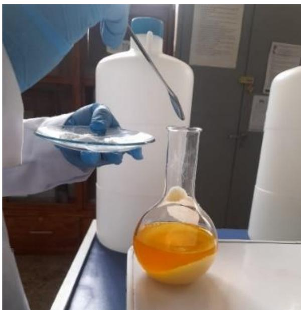
La reacción de sulfonación del metil éster se realizó a  $100^\circ\text{C}$  a presión atmosférica durante 4,5h. La reacción se llevó a cabo en una campana de extracción de gases. En la figura 20 se muestra la reacción de sulfonación.
