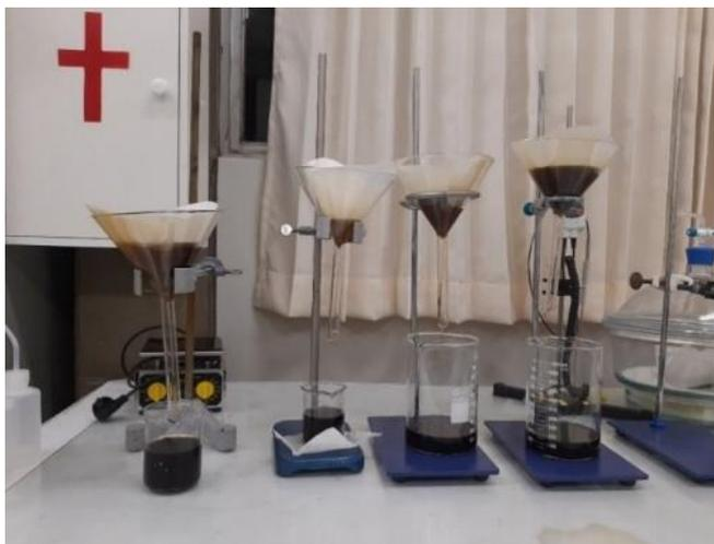
Posterior a la remoción de impurezas, el ACR fue calentado hasta 80 °C, se le añadió agua a 80 °C, fue mezclado en un agitador magnético manteniéndose constante la temperatura por 10 min, por las propiedades de solubilidad de la lecitina (goma); los fosfátidos, proteínas y otras impurezas coloidales se separaron por decantación en el agua (Bernardini, 1981). En la figura 15 se puede observar el desgomado y la separación.
