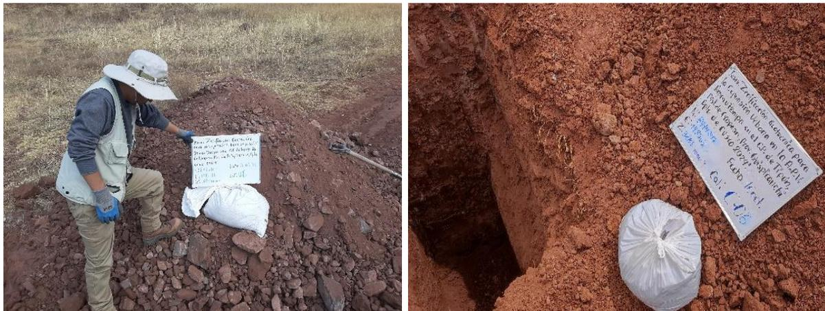
Seguidamente se levantaron perfiles estratigráficos considerando las características visuales de los estratos como: tipo de material, potencia, color, etc., posteriormente se realizó el ensayo de densidad natural en campo (cono de arena), culminando con el cierre de calicatas.
