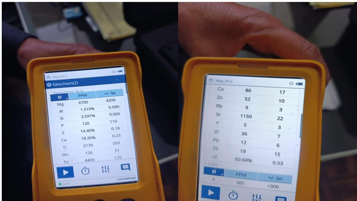
*Ensayo de espectroscopía de fluorescencia de rayos X en las sales solubles*
