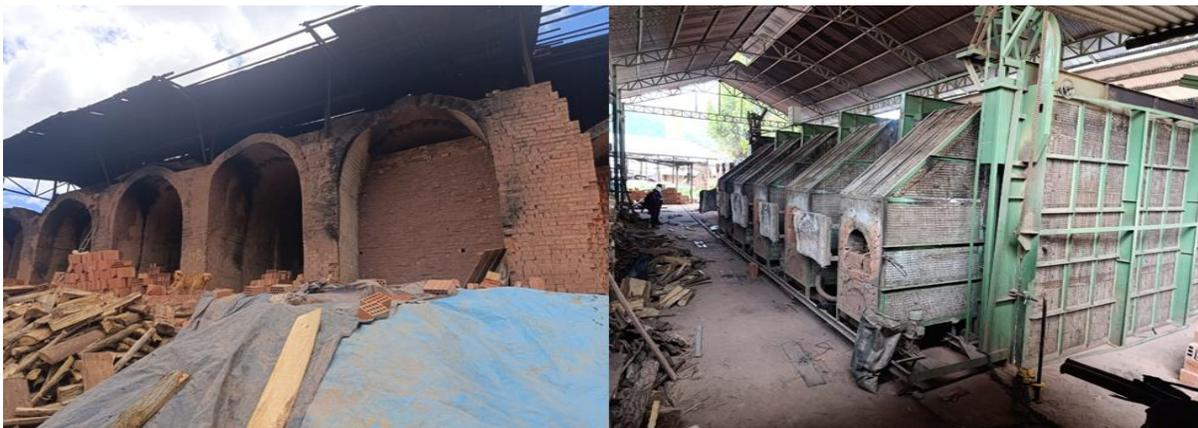
*Nota.* En las imágenes se observa las unidades en proceso de secados de forma natural sin el empleo de ventiladores mecánicos. Fuente: Elaboración Propia.
