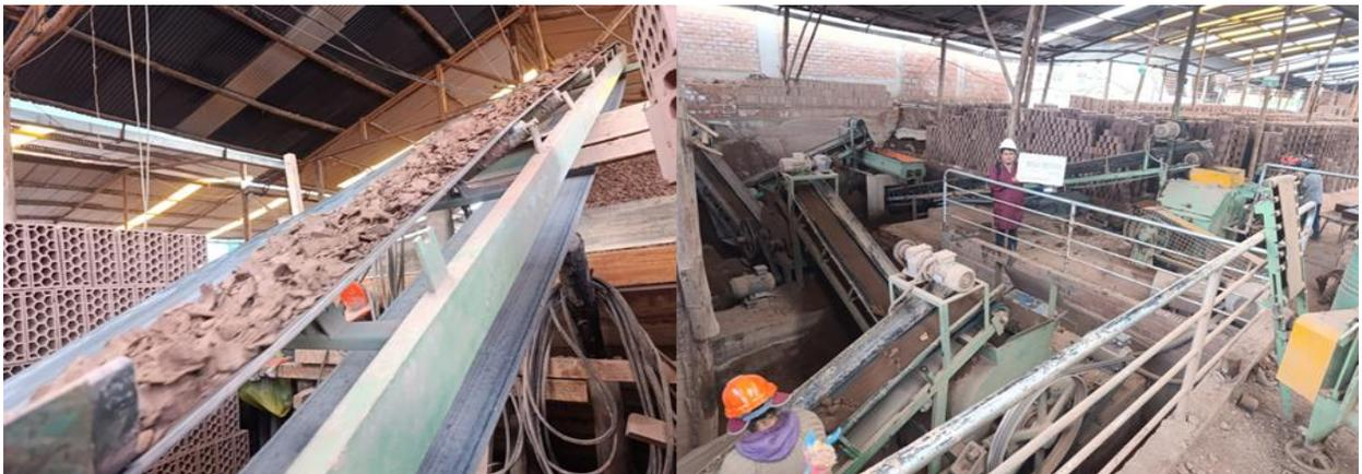
*Nota.* En las imágenes se observa el proceso de mezcla de la materia prima, y luego transportada a través de fajas a la máquina de laminado. Fuente: Elaboración Propia.
