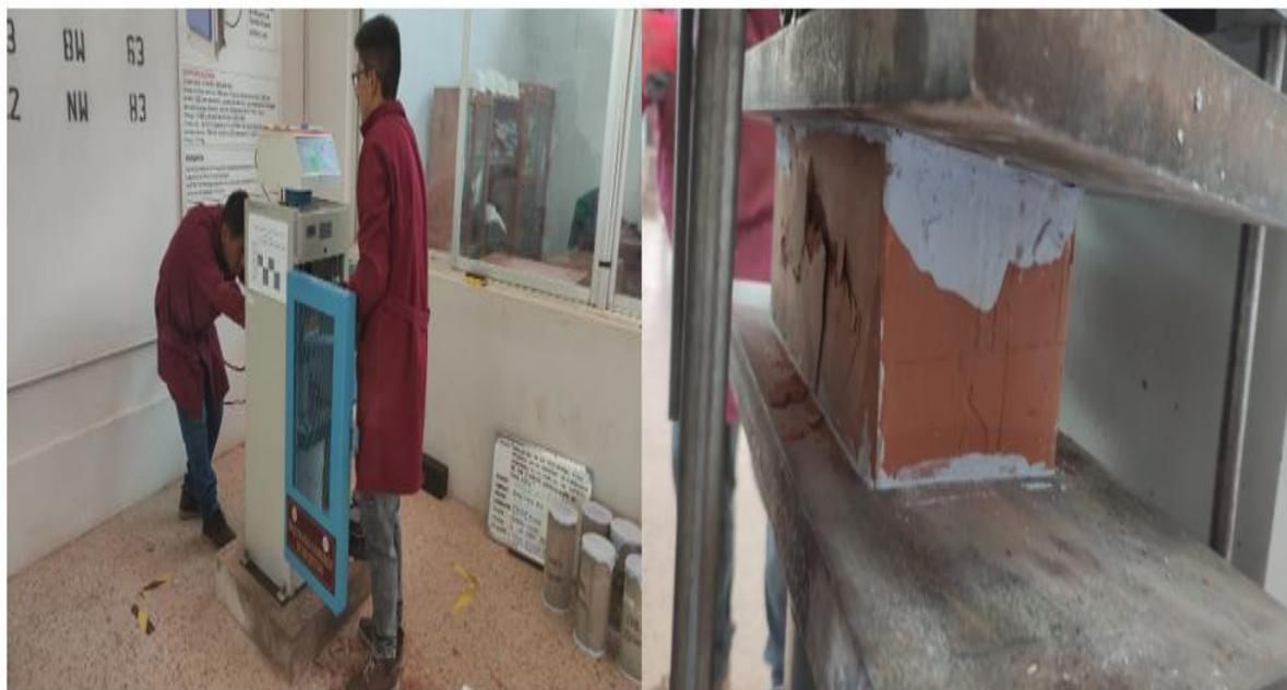
*Nota.* Desarrollo del ensayo de resistencia a compresión de unidades de albañilería.
