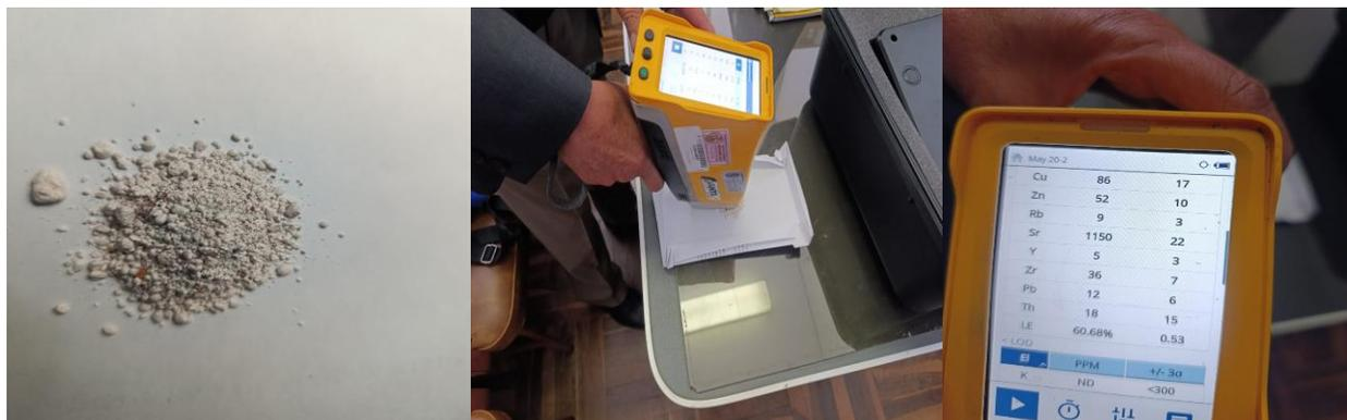
*Nota.* Mediante el equipo espectroscopía de fluorescencia de rayos X se identificó la composición química presente en los depósitos blanquecinos eflorecidos en los ladrillos.
