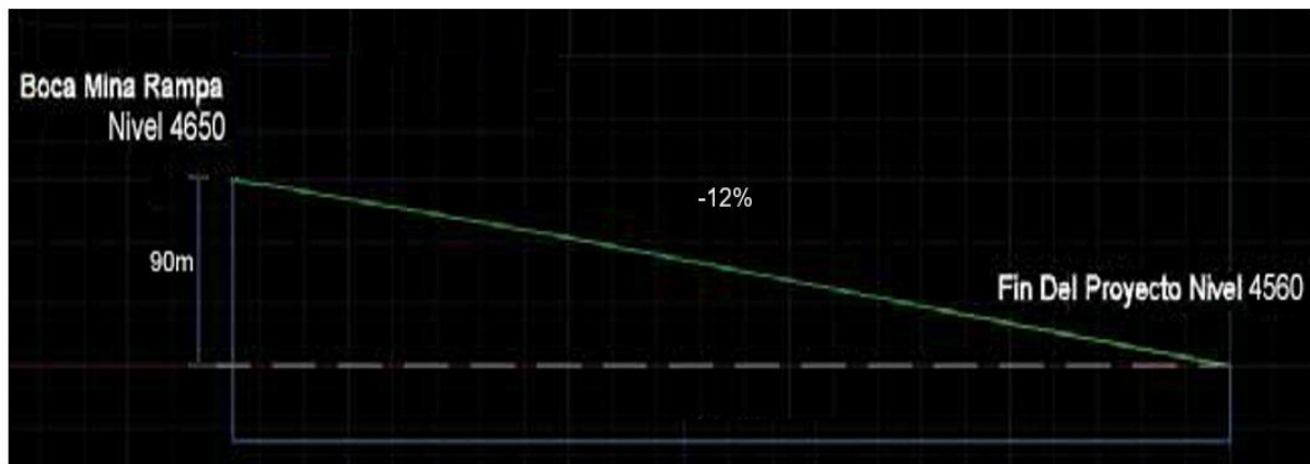
Figura 41 Rampa diferencia de Cotas
