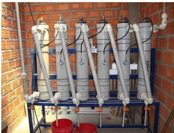
*Nota:* lixiviación en columnas con tubería PVC
