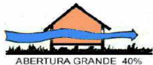
Figura 95 Aberturas para ventilación
