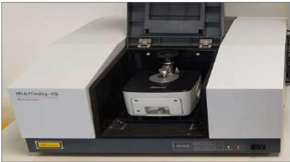
*Nota.* Equipo Espectrómetro FTIR con un accesorio de reflectancia total atenuada (ATR) (Aparicio Ceja & Carbajal Arizaga, 2015)
