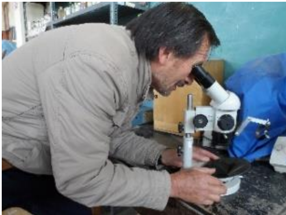
Fotografía 22. Observación del concentrado después del plateado con ayuda del microscopio estereoscópico
