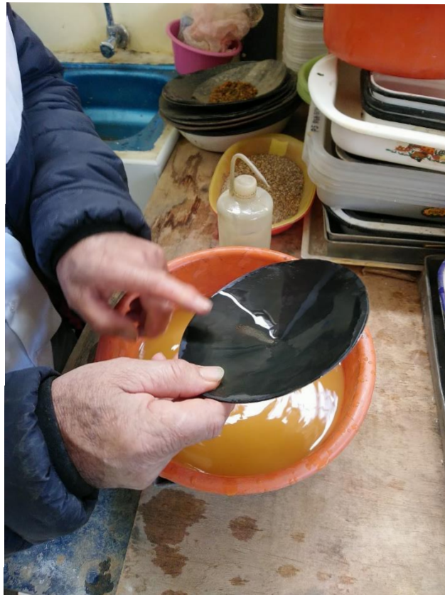
Fotografía 21. Plateo de muestra de concentrado del mineral flotado
