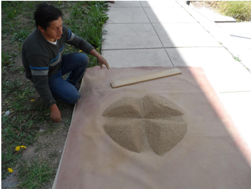
Fotografía 17. Preparación de muestra de mineral aplicando el método de cono y cuarteo
