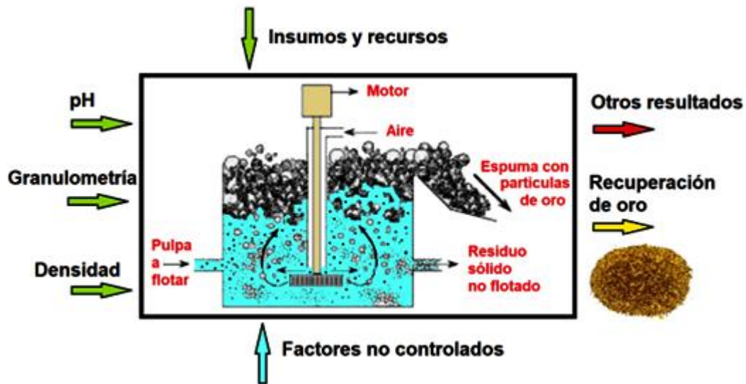
Figura 5. Caja negra del proceso de recuperación del oro por flotación con espuma
