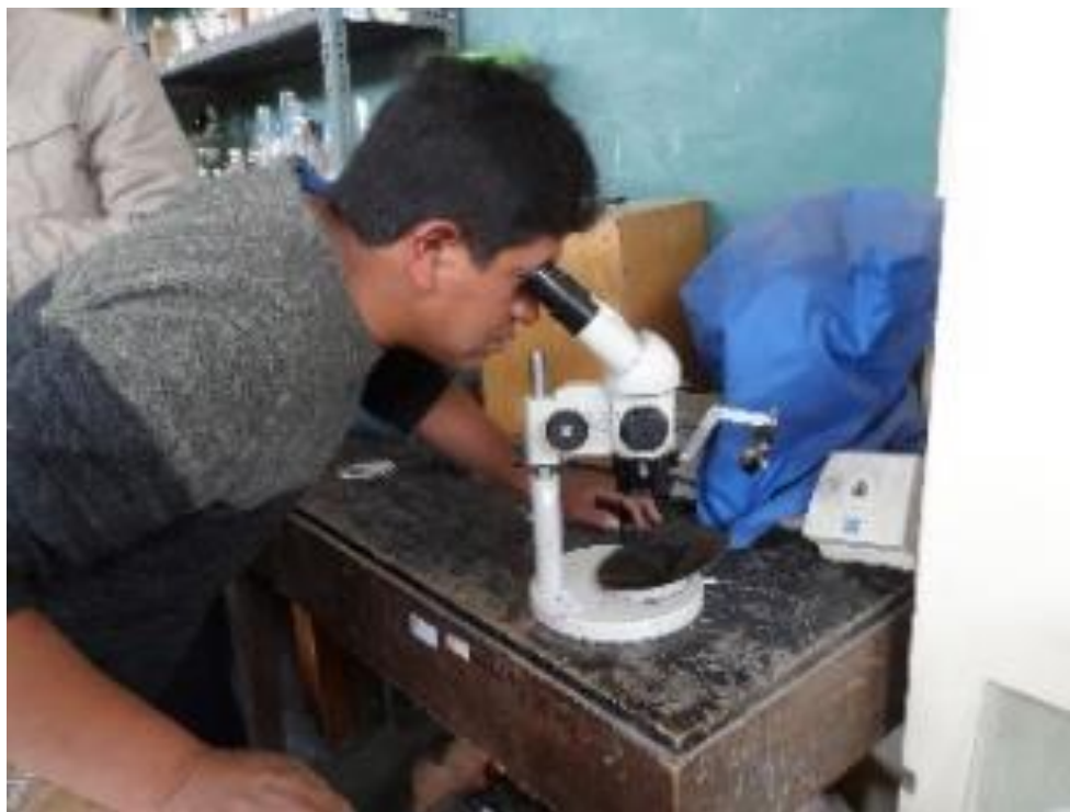
Fotografía 23. Observación del concentrado después del plateado con ayuda del microscopio estereoscópico
