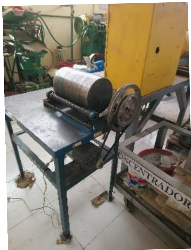
Fotografía 14. Molino de bolas del laboratorio de procesamiento de minerales de la UNSAAC
