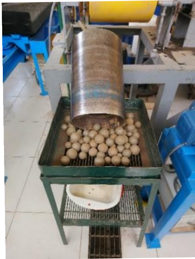
Fotografía 15. Descarga del molino de bolas del laboratorio de procesamiento de minerales de la UNSAAC
