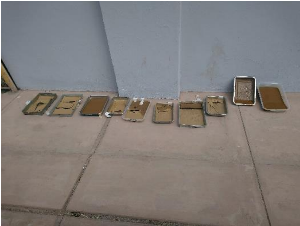
Fotografía 25. Secado a temperatura ambiente de los concentrados obtenidos después de la flotación.
