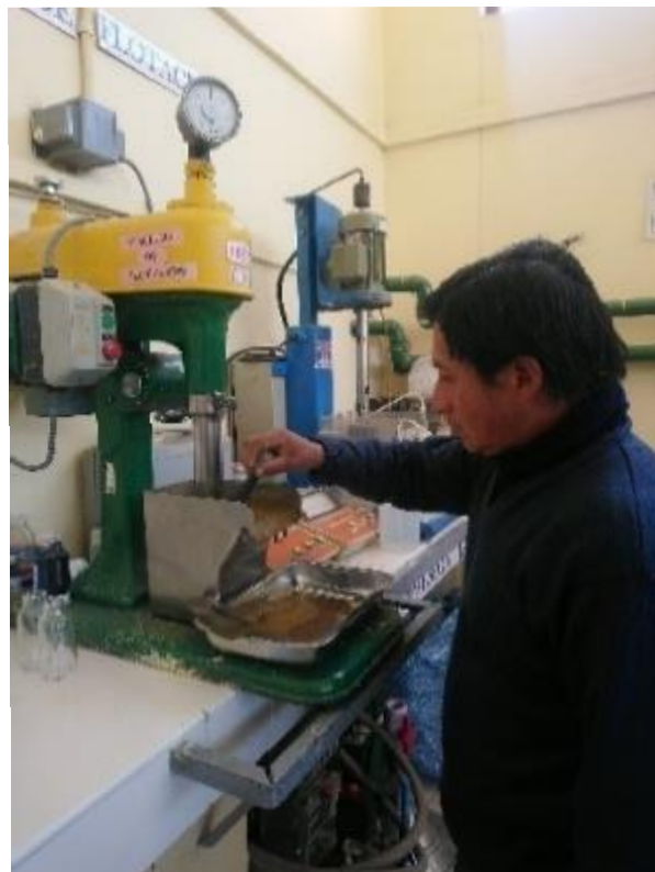
Fotografía 20. Flotación del mineral aurífero en las instalaciones de laboratorio de procesamiento.
