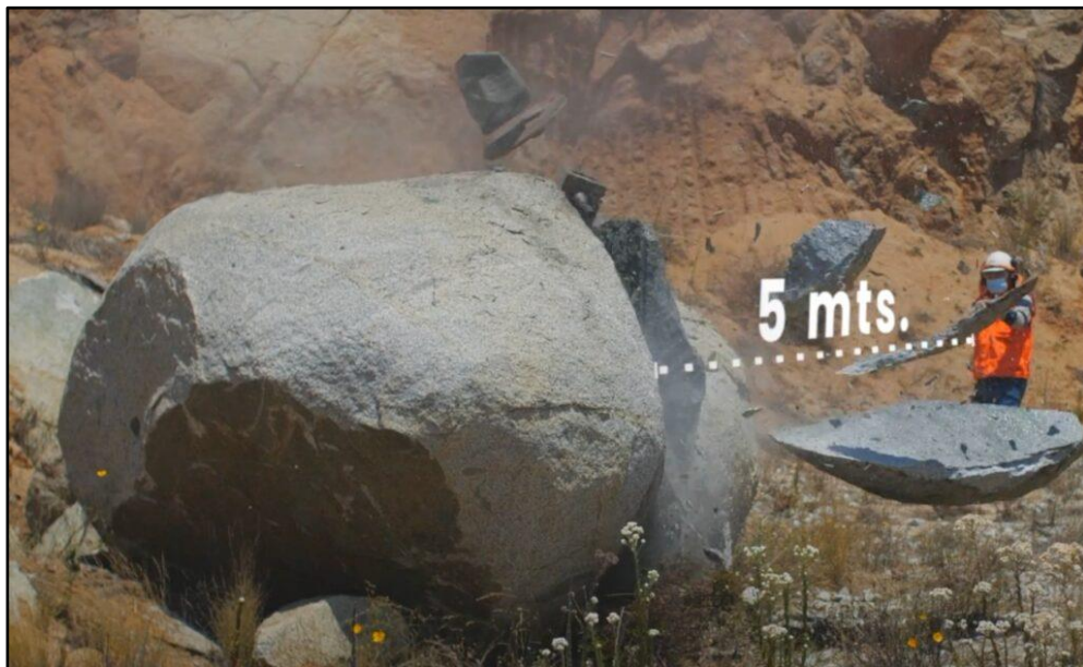
Figura 108. Reducción de tamaño mediante voladura controlada.
