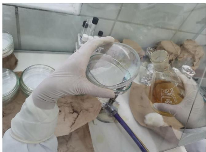
Fotografía N°14 y 15°: Preparación del medio de cultivo agar Sabouraud para la determinación de la actividad antifúngica por el método de Disco difusión y plaqueo con Sabouraud □
