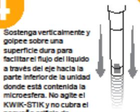
Sostenga verticalmente y golpee sobre una superficie dura para facilitar el flujo del líquido a través del eje hacia la parte inferior de la unidad donde está contenida la microesfera. No agite el KWIK-STIK y no cubra el pequeño orificio de ventilación en la parte superior del KWIK-STIK.
